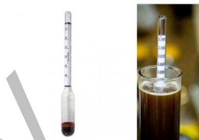
Figura 1.13 Densímetro, aparato para medir la densidad de los líquidos.
